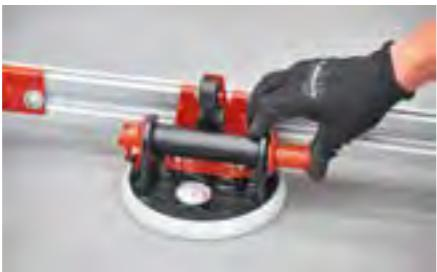
È consigliato l'utilizzo di apposite ventose vuoto idonee per la presa della lastra. Sollevare la lastra per il trasporto, controllando la tenuta delle ventose tramite il vuotometro.
