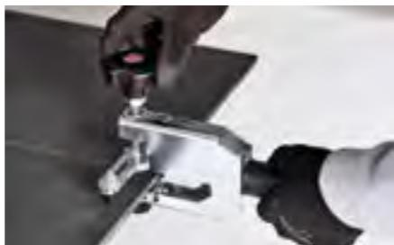
Usare apposite pinze troncatici per ottenere il taglio ottimale evitando la rottura del materiale.
