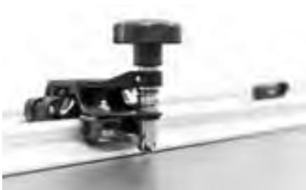
Si raccomanda di usare strumenti professionali: una guida di taglio provvista di ventose incorporate e di inciso con rotellina in titanio.
